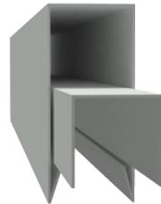
**ШАГ 3** С шагом 120 мм на стойках ① делаются метки, для крепления ламелей ②. Первая метка – это нижний или верхний край стойки ① (по желанию исполнителя). Ламели ② крепятся заклёпками ④\* с лицевой и с тыльной стороны секции. Зазор 40 мм. Для чёткой линии горизонта используйте уровень. Рекомендуем сначала завести все ламели ② секции в стойки ①, опустив их вниз, а затем крепить ламели ② по меткам, начиная сверху и опускаясь вниз.
